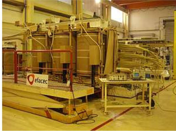
**Fig. 8.1. Montaje experimental con un transformador testado para realizar las mediciones de las oscilaciones transitorias durante el ensayo de picoteo.**
